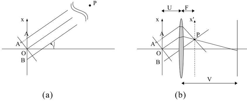
FIGURE 1.2 – Formation d'image vu comme une double transformée de Fourier.
