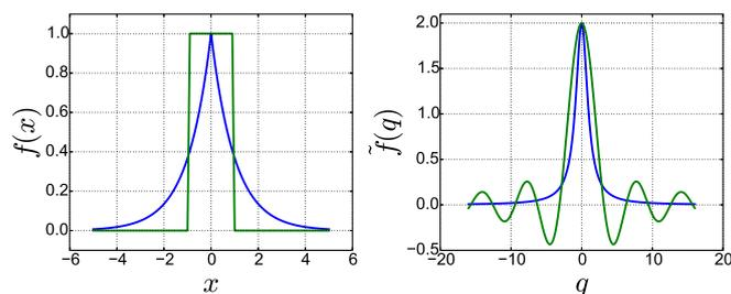
FIGURE 1.1 – Quelques exemples de fonctions et de leurs transformées de Fourier. En bleu, la fonction  $\exp(-|x|)$  ; en vert, la fonction  $\Pi(x)$ .
