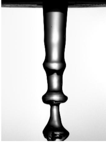
FIGURE 3 Image instantanée du jet sur laquelle on mesure la longueur d'onde de l'instabilité ( $u_1 = 0,45$  m/s,  $u_2 = 16,3$  m/s).
