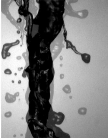
FIGURE 16 Brisure totale d'un ligament.
