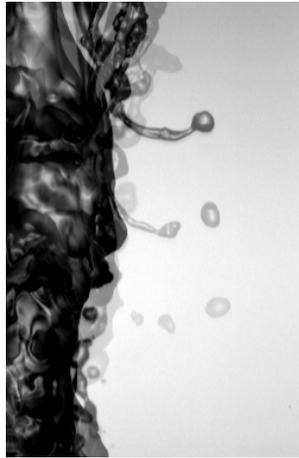
FIGURE 14 Formation de gouttes à partir d'un ligament  $u_1 = 0,71$  m/s et  $u_2 = 25$  m/s, la hauteur de l'image est de 20 mm.
